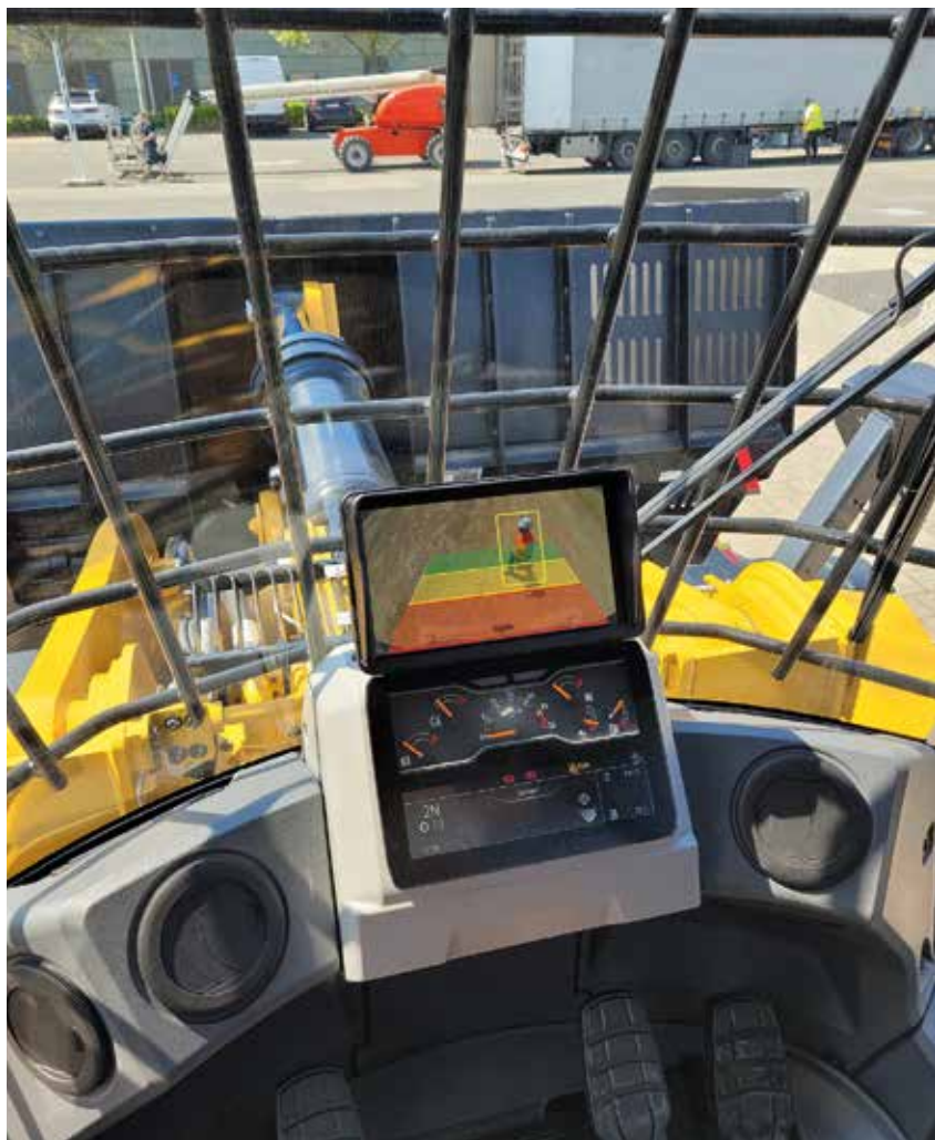
Personen im Blick: Die Kameras von MEKRATronics sorgen für mehr Sicherheit, unter anderem mit einem Rundum-Sichtsystem.
